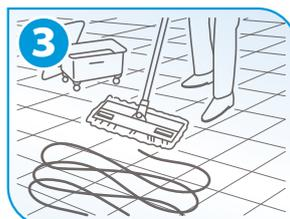
3 皮膜の汚れが目立つようになったら、専用洗剤の希釈液で表面洗浄した後、ニュースターダムを1~2回塗布します。
