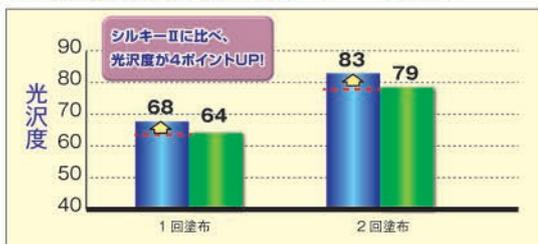
※ビニル床タイルに各ワックスを15g/m<sup>2</sup>ずつ塗布。60度光沢計で測定。
