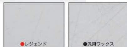
※オフィスビル通路のビニル床タイルに各ワックス3回塗布後、2ヶ月経過した塗膜の概観状態を比較
