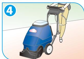
④ リンサーの1:30希釈液をエクストラクターの洗剤タンクに入れ、エクストラクションをします。
