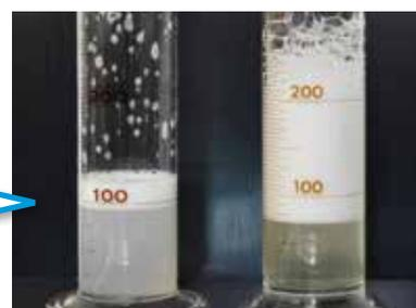
**試験方法** ガラスシリンダーに、各はく離剤の10倍希釈液入れ、良く振とうした後、静置し、泡の高さを観察した。
