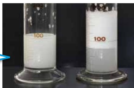
**試験方法** ガラスシリンダーに、各はく離剤の10倍希釈液入れ、良く振とうした後、静置し、泡の高さを観察した。
