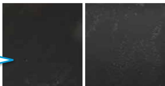
**試験方法** 化学床タイルに各はく離剤の10倍希釈液をウェスで塗布した後、静置し、はく離液の塗れ具合を観察した。
