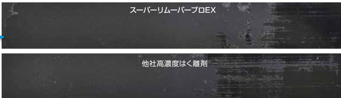
**試験方法** ワックス皮膜をオープンで処理し硬化した後、各はく離剤の10倍希釈液で、白パッドを装着したウオッシュアビリティ試験機を用いはく離洗浄した。
